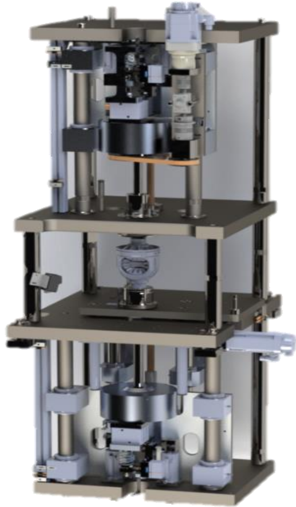
Messung Axialspiel Differentialgetriebe End-of-Line
